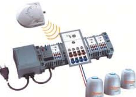
Οι θερμοστάτες του χώρου λειτουργούν ως πομποί και η βάση ως δέκτης, δίνοντας εντολές στους θερμοηλεκτρικούς κινητήρες του συλλέκτη να ανοίγουν και να κλείνουν τα κυκλώματα χωρίς τη χρήση καλωδίων.
