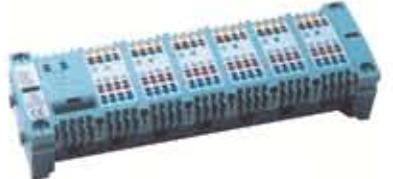
Παίρνει εντολή από τους θερμοστάτες και τη μεταφέρει στους θερμοηλεκτρικούς κινητήρες του συλλέκτη, ώστε να ανοίγουν και να κλείνουν τα κυκλώματα σύμφωνα με την επιθυμητή θερμοκρασία του χώρου.
